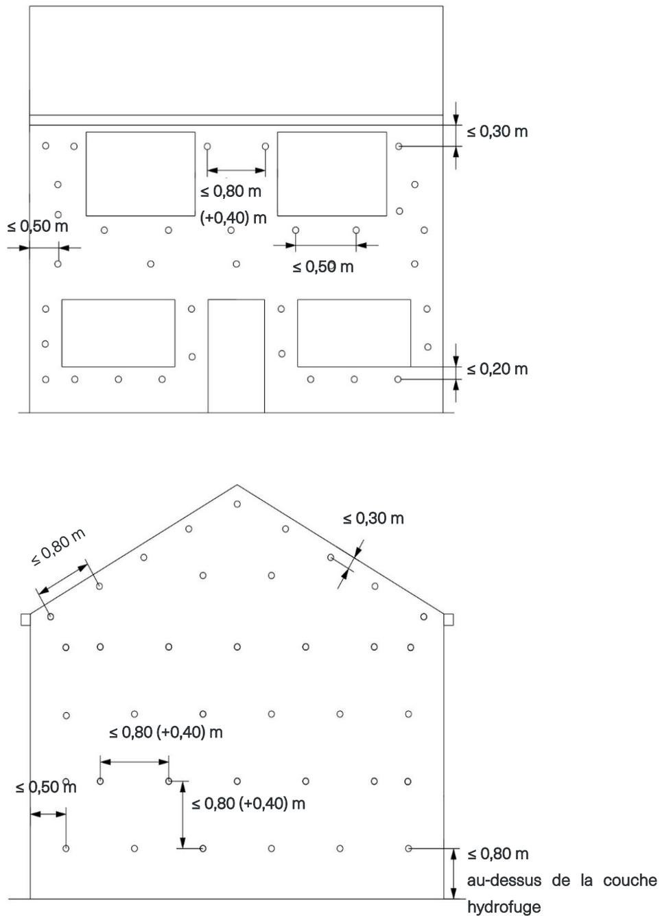
Fig. 1: Représentation schématique du schéma de remplissage
